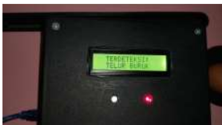
Gambar 10. Kondisi LCD dan LED ketika Telur dalam kondisi Buruk
